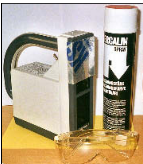
Utrustning för spraytest (UV-lampa och sprayfärg).
