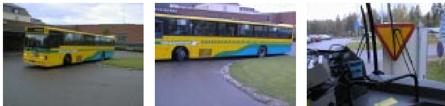
Vändplan vid sjukhuset där bussarna inte tar sig runt utan att backa
