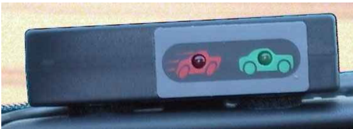
Figur 5-3 Fartkollare monterad i ett försöksfordon.
