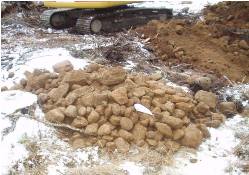
Figur 2.1 Sten- och blockhalt kan bestämmas genom att sten och block sorteras ut och placeras i koniska högar vars höjd sedan bestäms, se även bilaga 3.
