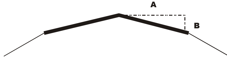
Figur 5 Princip för beräkning av tvärfall.
