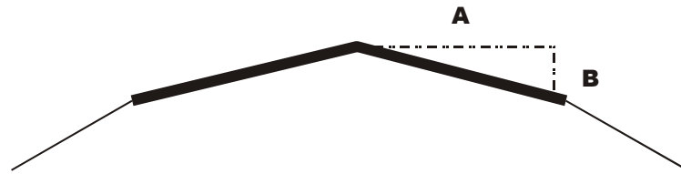
Figur 5 Princip för beräkning av tvärfall.
